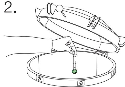
Pour y remédier, déposez une gélule (ou 2 si l'odeur est très forte) dans l'eau au fond de l'autoclave ou dans un béccher d'eau (autoclave à vapeur).
